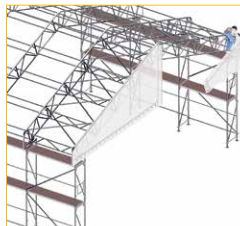
► Installazione dei teli Keder di timpano
