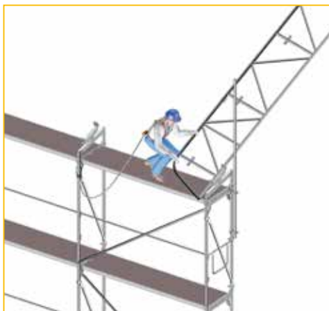
► Installazione della prima capriata
