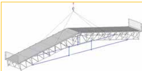
► Sollevamento con gru della campata completa
